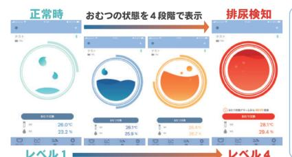
要介護者が履くおむつにセンサーを取り付けることで、おむつの温度と湿度を測定します。 温度と湿度をもとに、おむつの状態を 4 段階 で識別しアプリの画面に表示。レベル 4 に達 するとアプリはアラームを発してお知らせを します。
